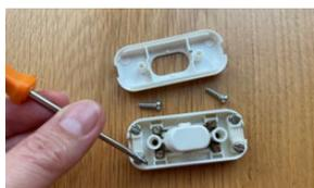
Démontons un interrupteur pour comprendre comment il fonctionne [FMTTN 4.1]. Ajoutons-le au circuit. Testons. Que faut-il pour que le courant passe et que la lampe s'allume?
